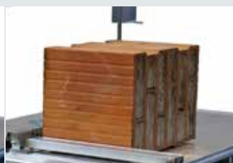
Brique poreuse remplie de perlite
