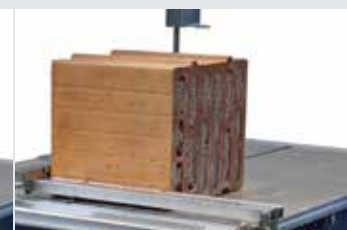
Brique poreuse remplie de laine minérale
