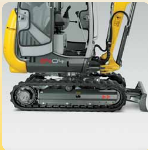
Il meccanismo di traslazione particolarmente lungo e largo si muove anche su terreni accidentati in piena sicurezza. L'agilità e la forza dell'escavatore possono essere sempre pienamente sfruttate.
