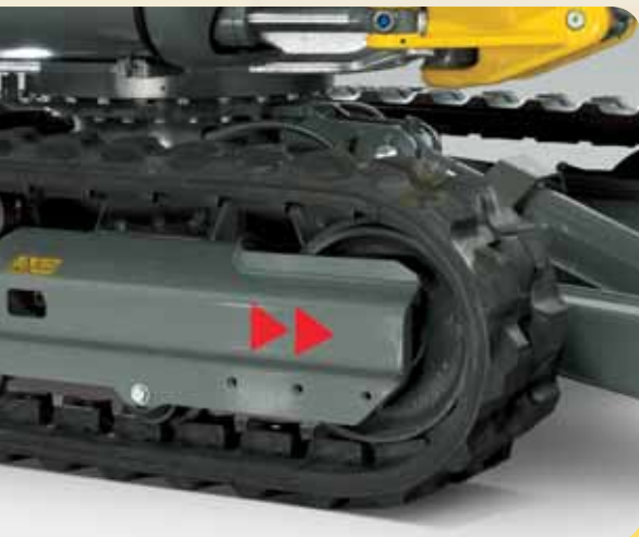
Il meccanismo di traslazione autopulente elimina tutto lo sporco già durante il movimento.
